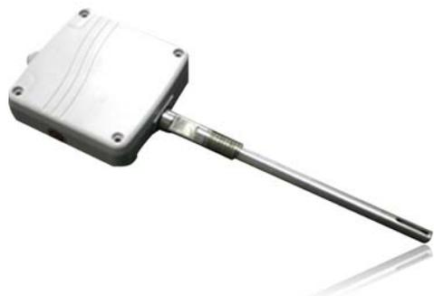
WS402 高温型温湿度变送器，可在环境 ( $<120^{\circ}\text{C}$ ) 湿度测量，敏感元件和变送电路分体结构，标准电流/电压信号输出，线性响应，专用电路，测量范围宽、精度高。
