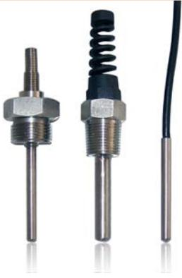
TS 系列温度传感器采用进口 PT100、PT1000 薄膜铂电阻为敏感件，线性好，精度高，并且采用全金属密封结构和激光焊接工艺，灌充高绝缘导热弹性硅胶，抗振动，导热快，适合于液体气体的温度测量与控制。
